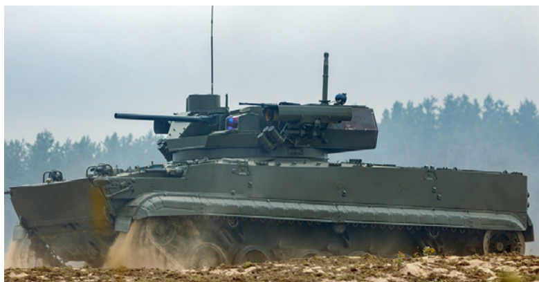
Сн. 2. Пехотна машина Б-19 с боен модул „Епоха“
