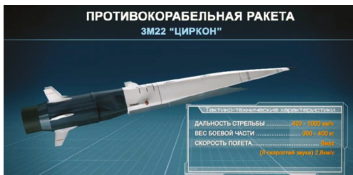
Фиг. 9. Основни данни на хиперзвукова ракета „Циркон“
