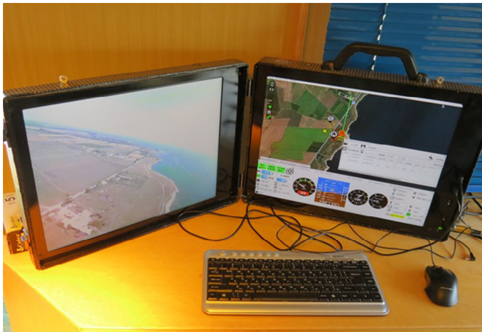
Сн. 1. Унифицирана наземна станция в развърнато положение
