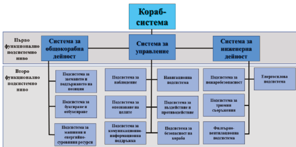
Фиг. 1. Функционална йерархична структура на кораба-система
