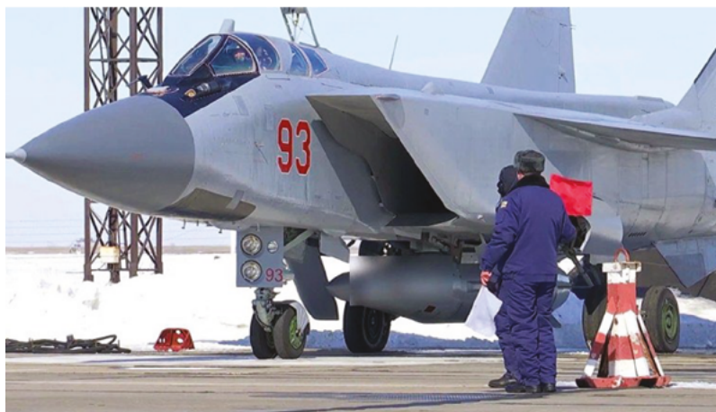
Фиг. 5. Балистична ракета „Кинжал“, подкачена на изстребител МиГ-31К
