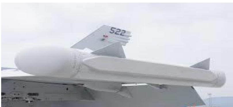
Фиг. 1. Цифров приемник на радиолокационни сигнали AN/ALQ-218
