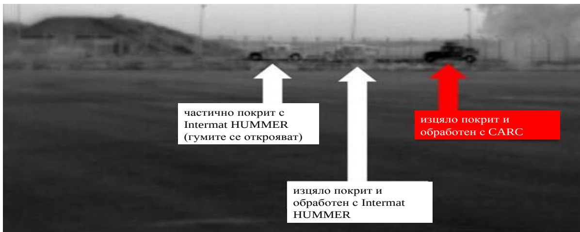
Сн. 11. Сравнение на възможностите за намаляване на отражаемата повърхност между Interimat и Chemical Agent Resistant Coating в инфрачервения спектър
