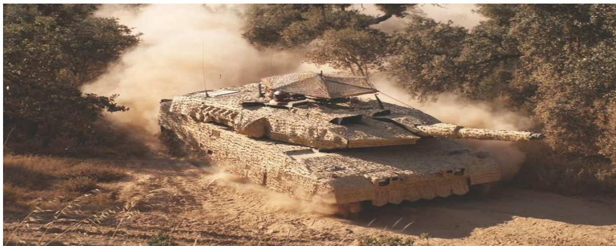
Сн. 8. Технологията Mobile Camouflage System (MCS) по време на изпитания
