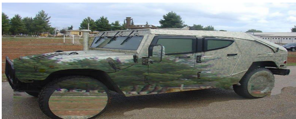
Сн. 8. Технологията Mobile Camouflage System (MCS) по време на изпитания
